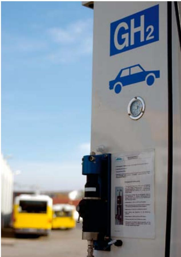
**An dieser Zapfsäule können Wasserstoff-Busse und -Pkws mit gasförmigem (CGH<sub>2</sub>) Wasserstoff betankt werden.**
